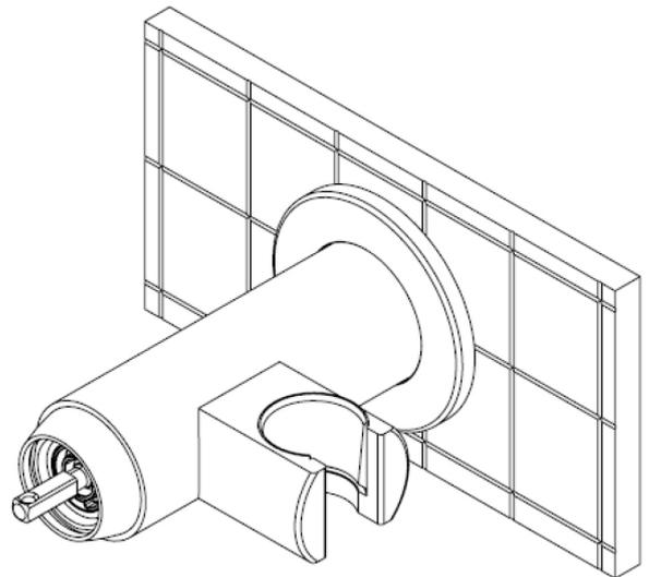
Avvitare il raccordo presa acqua sotto al corpo posizionando l'o-ring nella sede del raccordo.
