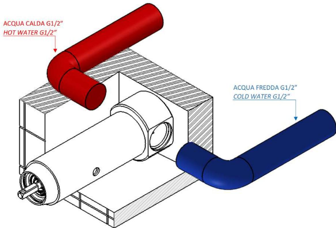
Forare la piastrella con un diametro minimo di 40 mm. e massimo di 55 mm.
